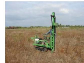
Sondage au pénétromètre
